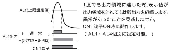
1度でも出力領域に達した際、表示値が出力領域を外れても比較出力を継続します。異常があったことを見逃しません。CNT端子ON時に動作します。(AL1~AL4個別に設定可能。)
