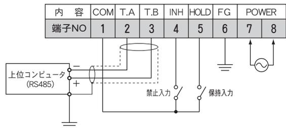
**INH(禁止)入力：**信号ON間、データ送受信を行わず現在表示値を保持します。その際、表示値は点滅します。（通信禁止状態）
