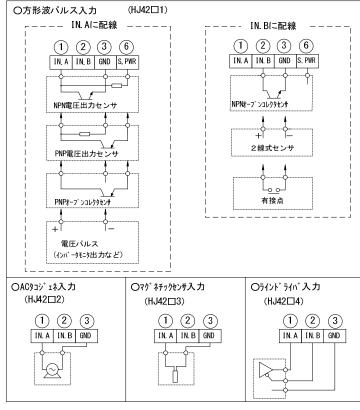
(注)方形波パルス入力は IN.A または IN.B の 2 箇所に上記の 通りセンサー仕様に合せて配線して下さい。 なお、IN.A、IN.B 同時に配線しないで下さい。
