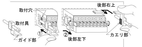
取付具ねじ締付トルク 0.15N.m~0.3N.m
