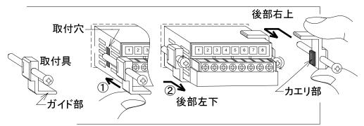
取付具ねじ締付トルク 0.15N.m~0.3N.m
