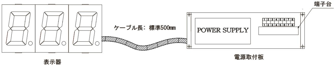
・ケーブル長は、標準 500mm で製作します。（ケーブル長変更の場合は別途指示。）
