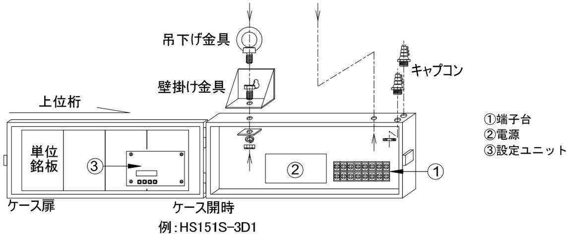
本体ケース上部に2箇所キャプコンが取り付けます。入力信号引込用及びA C電源引込用として御使用下さい。
