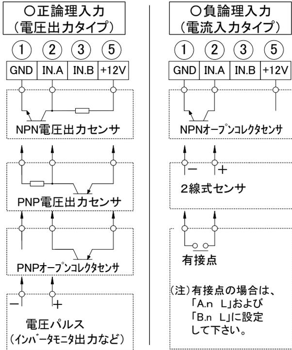
入力端子は IN. A(②)／IN. B(③)の2箇所、必要に応じて端子⑤の+12V センサー供給用電源に左記の通り配線して下さい。
