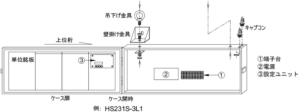
本体ケース上部に2箇所キャプコンが取り付けます。入力信号引込用及びA C電源引込用として御使用下さい。
