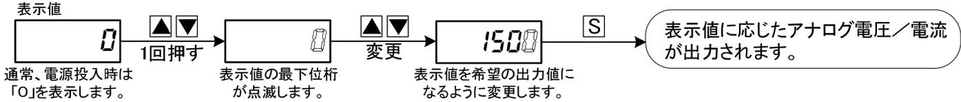
※数値変更中（最下位桁点滅）の状態でも60秒間キー操作がなければ通常表示に戻ります。
