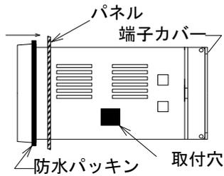
防水パッキンを取付け、本体をパネルに前面から挿入します。
